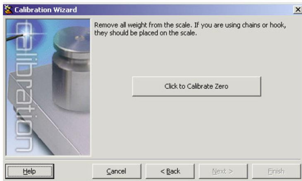
图:4-6. iRev 4 零点校准界面
