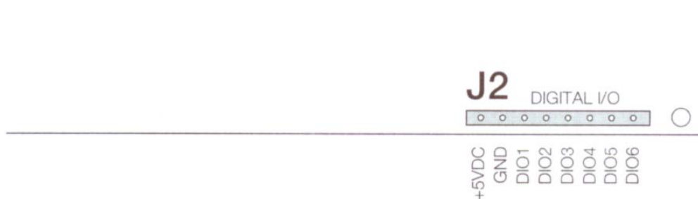
图： 2-8. 920i Rev H 及更高版本 CPU 主板上的 J2 插脚
