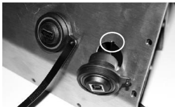
图：2-1. 后盖上密封的 USB 接头
